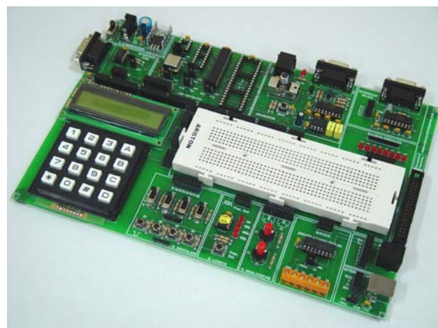
Figura 1.- Fotografía del sistema de desarrollo PIC School. Cortesía de Ingeniería de Microsistemas Programados S.L..
